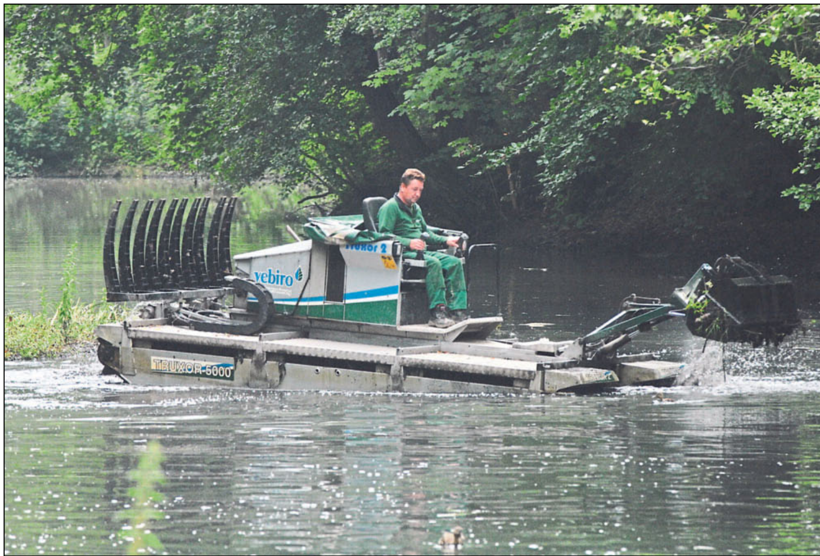
Trainer Track steuert den Truxor über den Teich, um den Schlamm mit Schaufel und Rechen aufzulockern.
