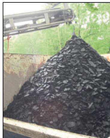
So sieht der getrocknete und gepresste Schlamm, genannt »Filterkuchen«, vor dem Abtransport in Mulden aus.
