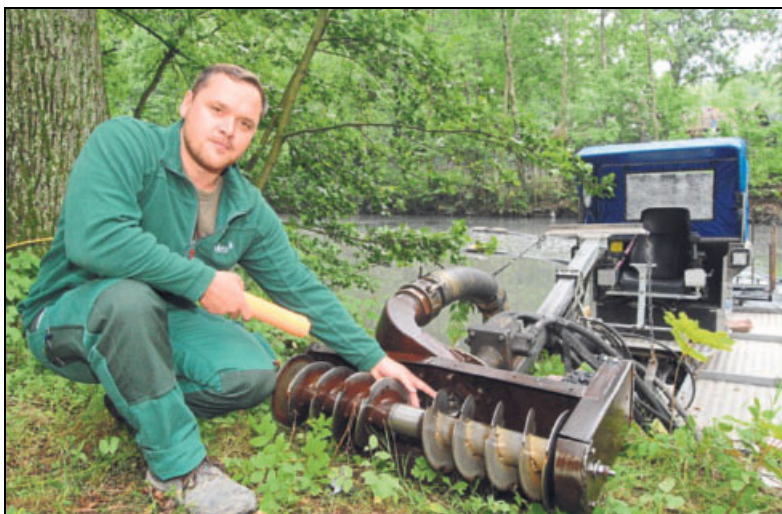
Robert Quicker zeigt die Schnecke, mit der der Morast in den Ansaugschlauch geschaufelt wird, um dann abgepumpt zu werden.
